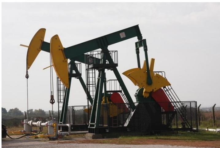
Slika 3.2. Izgled pumpne bušotina
